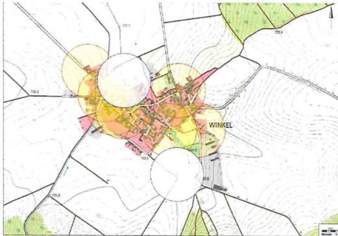
Hydranten (rote Kreise)
